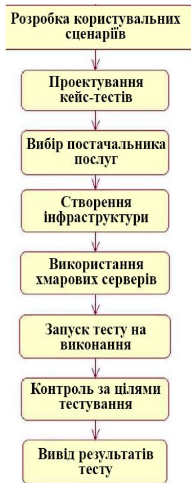
Рисунок 1.10 – Послідовність хмарного тестування ПЗ на основі моделі TaaS
