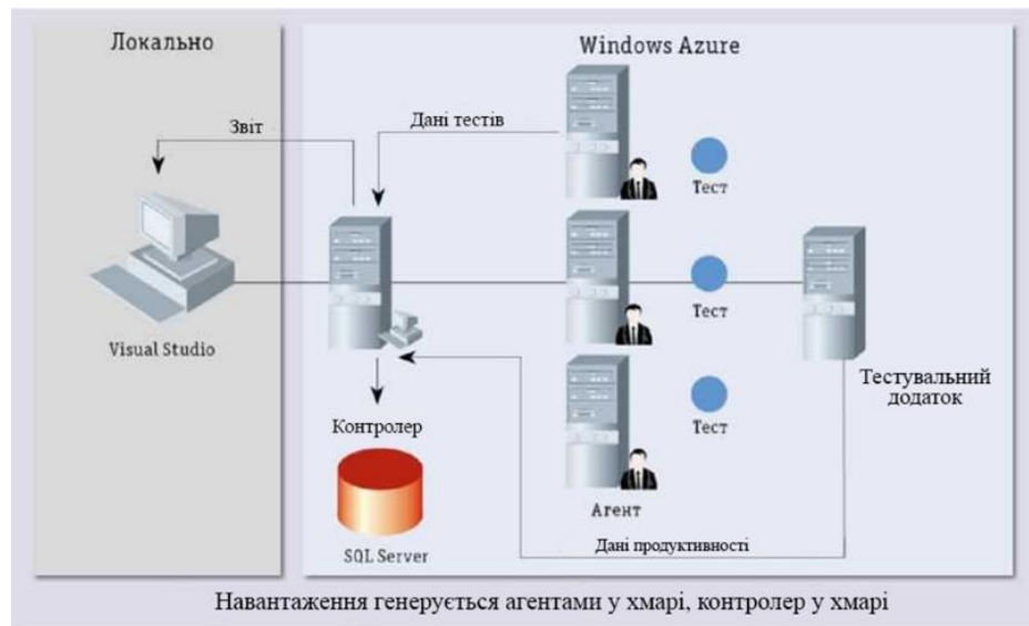
Рисунок 1.8 - Структурна схема моделі хмарного тестування навантаження в Visual Studio/TFS
