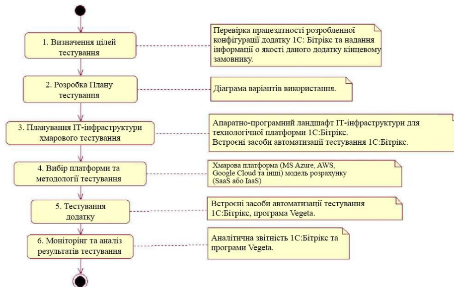
Рисунок 3.2 - Діаграма діяльності моделі хмарного тестування застосунку 1C8
