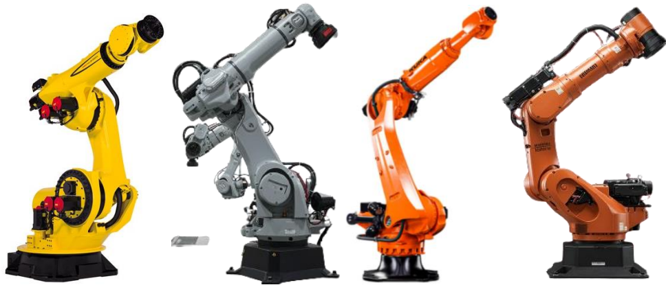
Рис. 1.5. Зовнішній вигляд послідовних (антропоморфних) роботів-маніпуляторів
