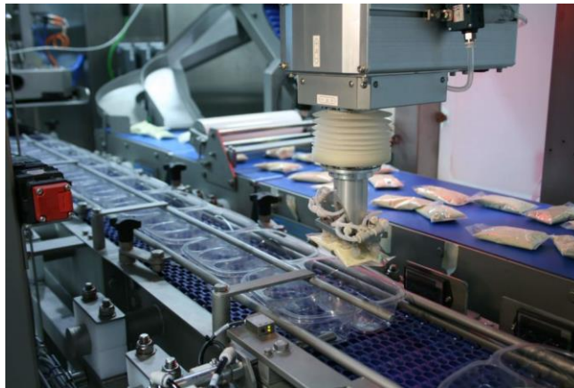
Рис. 1.9. Робот що пакує продукцію у пластикові контейнери.
