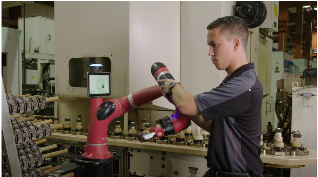
Рис. 1.14. Оператор в режимі Zero gravity mode направляє маніпулятор в необхідну йому точку
