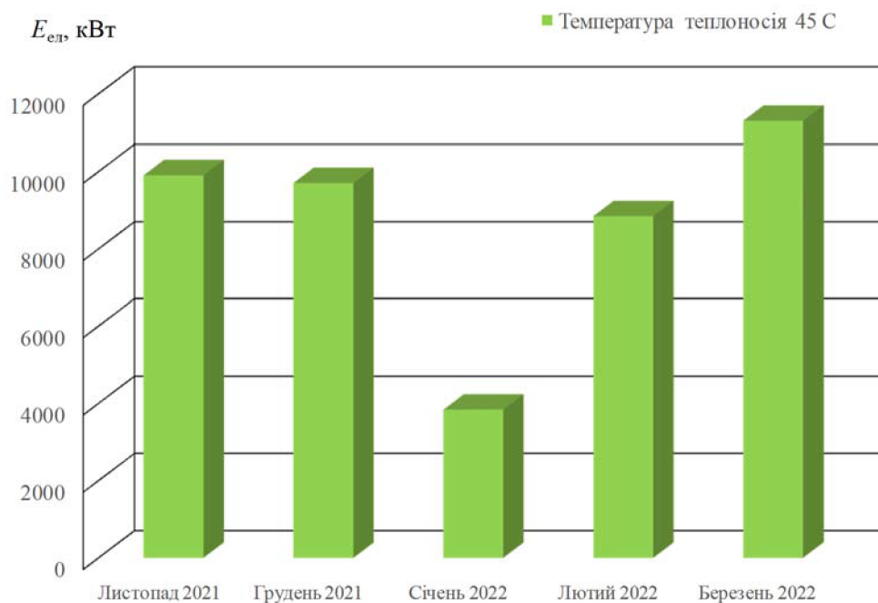
Рис. 4.4. Залежності споживання електричної енергії для комбінованої схеми із тепловим насосом E_{ел} по місяцях при температурі теплоносія в системі опалення t_{w1} = 45\text{ }^{\circ}\text{C} .
