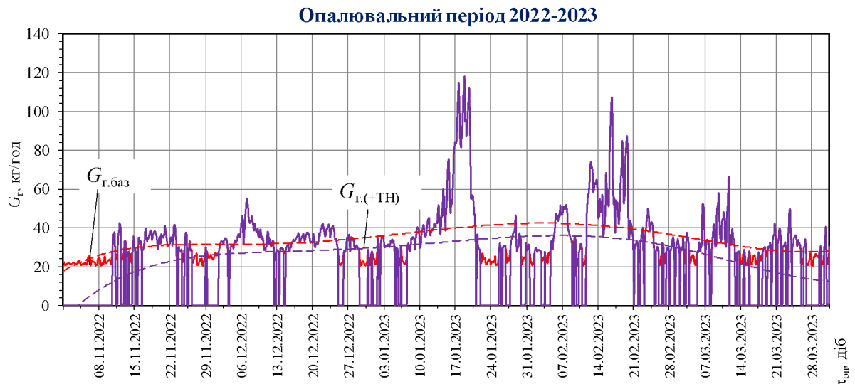
Рис. 4.6. Залежності питомої витрати природного газу для базової схеми із газовим котлом G_{T.\text{баз}} та витрати природного газу для комбінованої схеми із тепловим насосом G_{T.(+TH)} .
