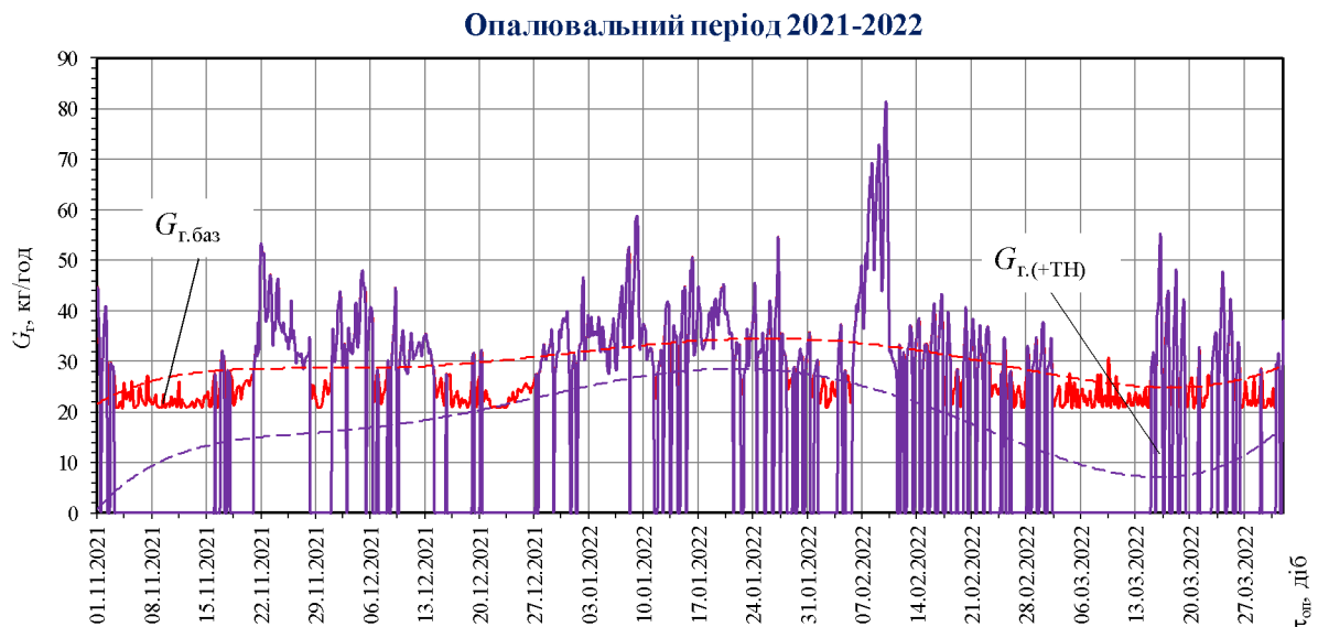
Рис. 4.1. Залежності питомої витрати природного газу для базової схеми із газовим котлом G_{г.баз} та витрати природного газу для комбінованої схеми із тепловим насосом G_{г.(+TH)} .
