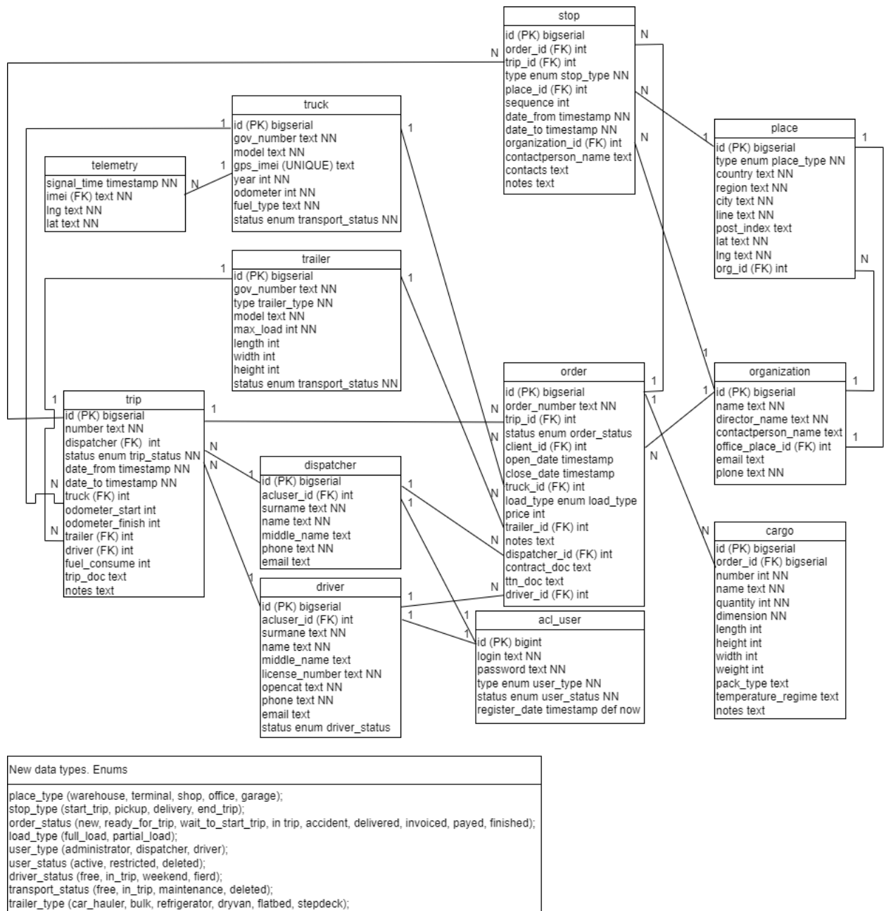
Рисунок 2.13 – Фізична модель даних програмного забезпечення для автоматизації роботи диспетчерського відділу
