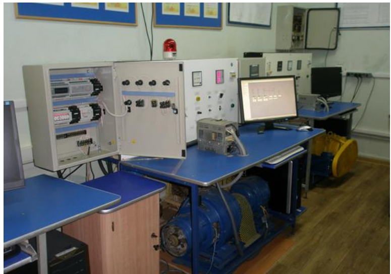
Рис. 4.15. Модель СЕУ: а – щит управління ГА; б – склад моделі СЕУ
