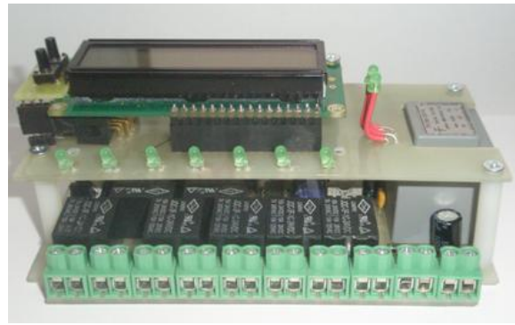
Рис. 4.14. Конструктивне виконання: а – контролера автоматизації; б – системи синхронізації і розподілу навантажень
