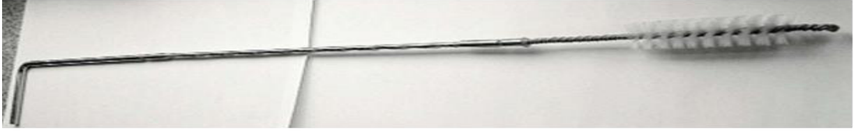
Рисунок 3.7 — Інструмент для механічного очищення трубної касети у зібраному стані
