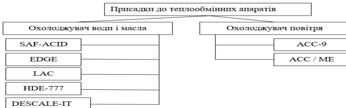
Рисунок 2.3 — Класифікація хімічних присадок і реагентів для обслуговування суднових охолоджувачів води, оливи та повітря
