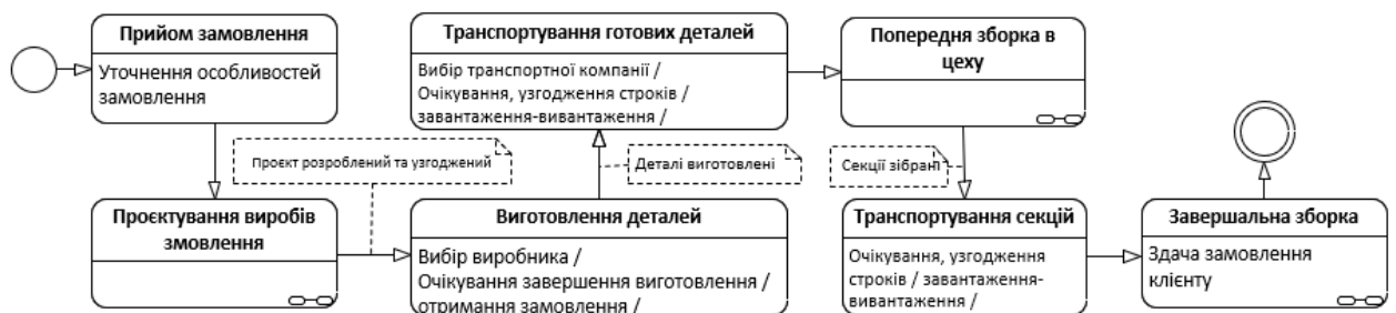
Рисунок 1.3. Модель процесу виготовлення індивідуального замовлення
