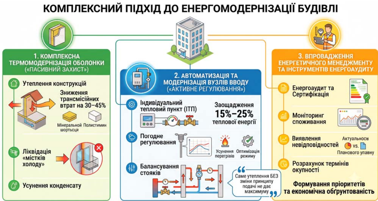
Рис. 1.3. Комплексний підхід до енергомодернізації будівлі.
