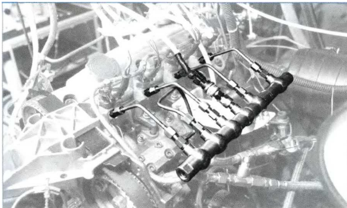
Рисунок 3.5 – Дизель із системою впорскування Common Rail на моторному випробувальному стенді
