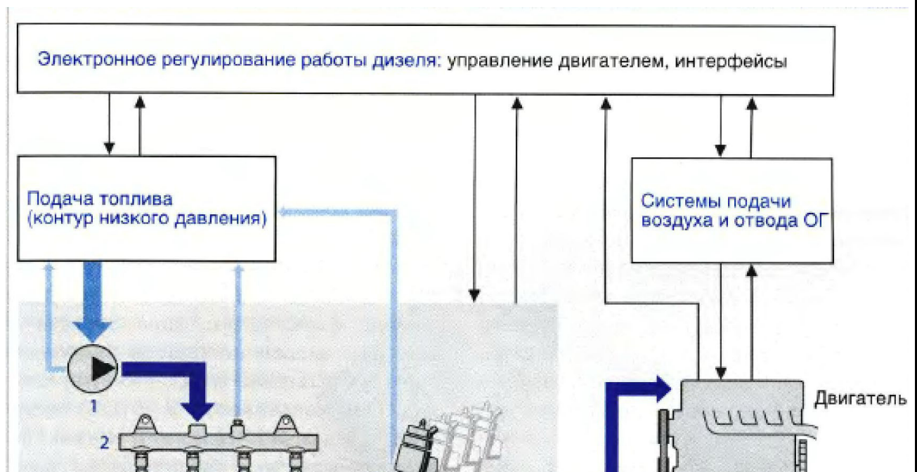
Рисунок 3.1 – Принципова схема керування дизелем з акумуляторною системою впорскування палива Common Rail:
