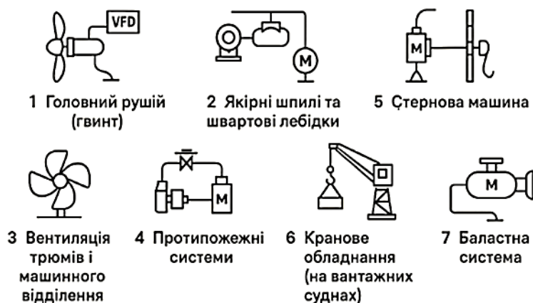
Рисунок 1 – Системи автоматизованого суднового електроприводу
