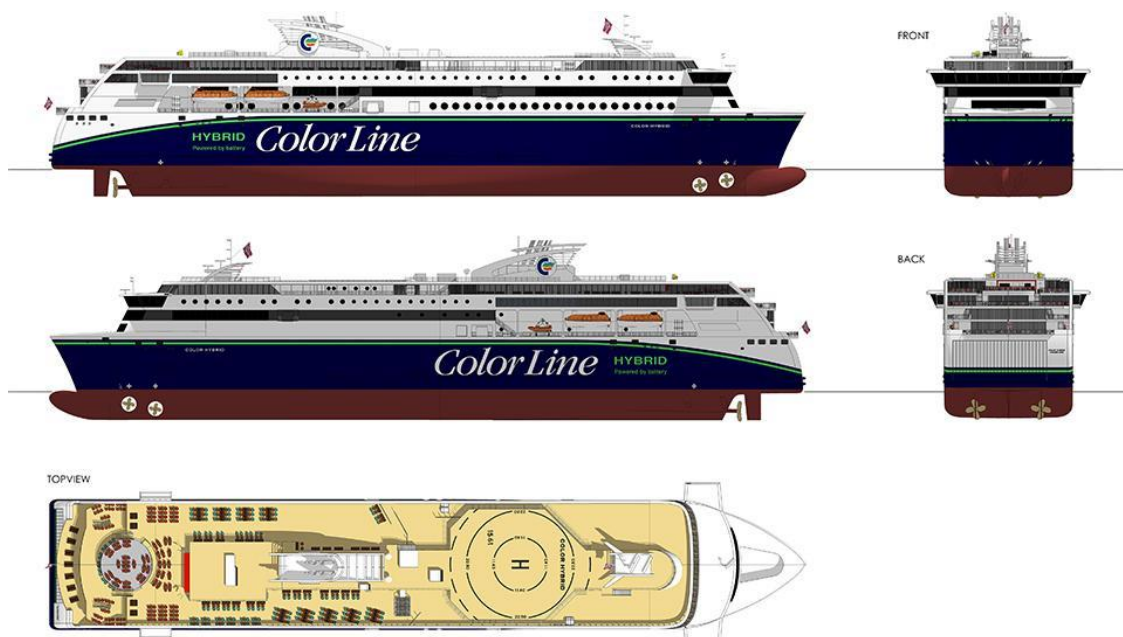
Рисунок 3 – Пасажирсько-автомобільний пором, що працює в гібридному режимі – Color Hybrid (Норвегія)
