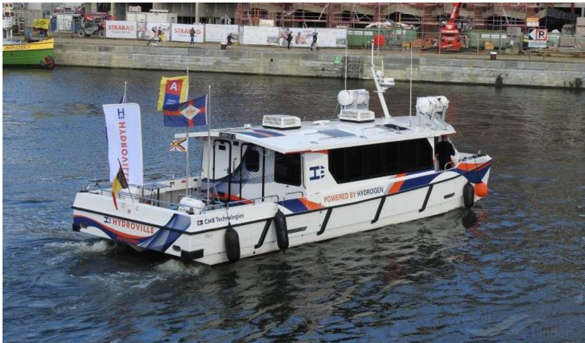
Рисунок 5 – Пасажирське судно на водневих паливних елементах Hydroville (Бельгія)
