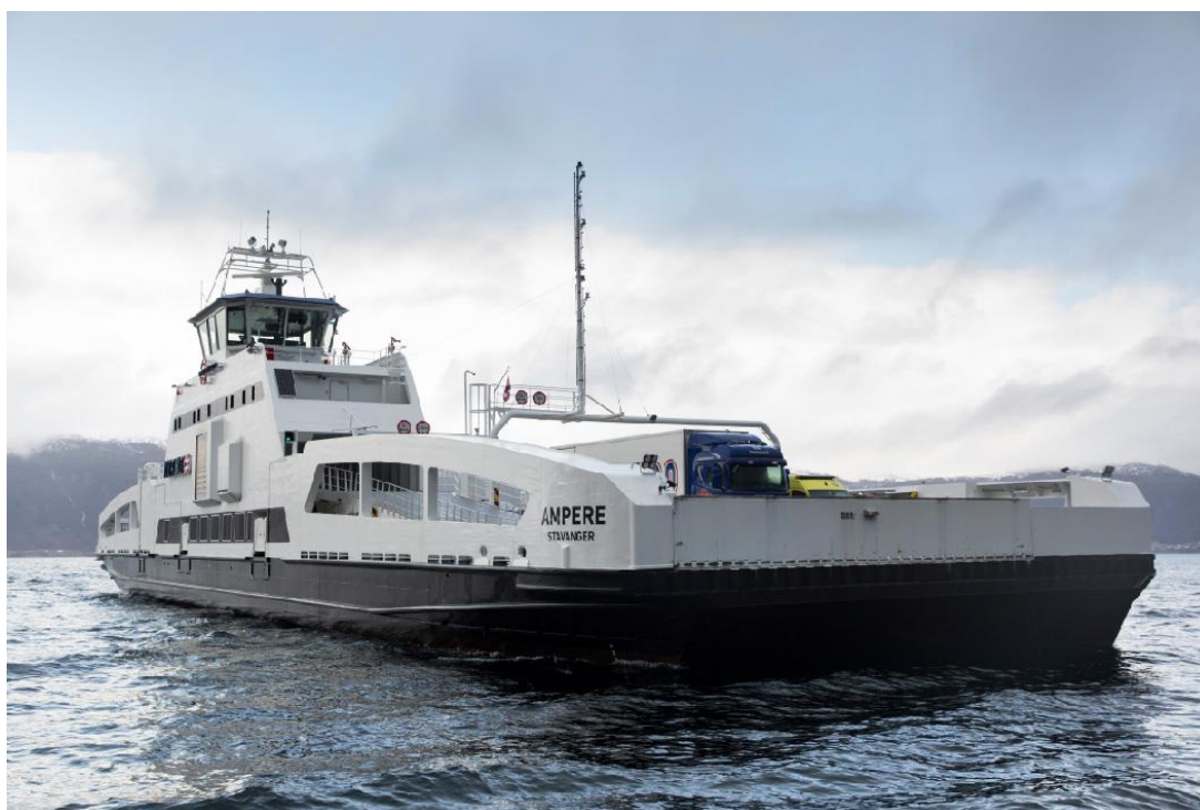
Рисунок 1 – Перший у світі повністю електричний автомобільний пором Ampere
