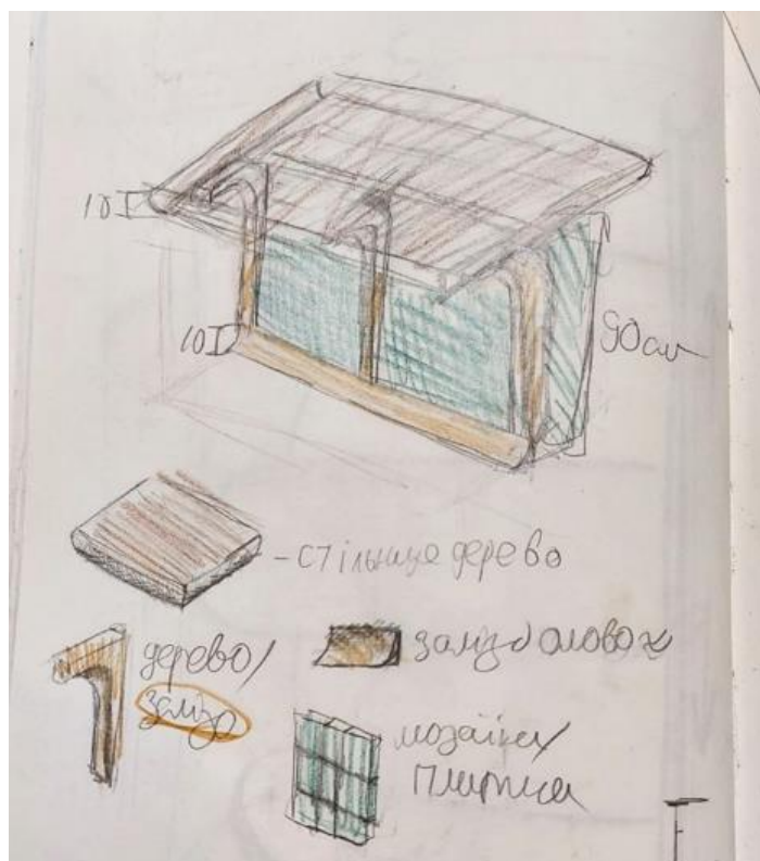
Рис. 19 – Ескіз конструкції барної стійки з позначеннями матеріалів кожного компоненту
