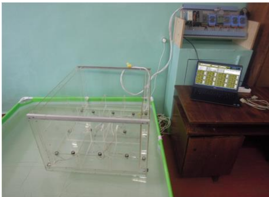
Рис. 4.11. Фото експериментального стенду плавучого доку із комп'ютерною системою контролю параметрів
