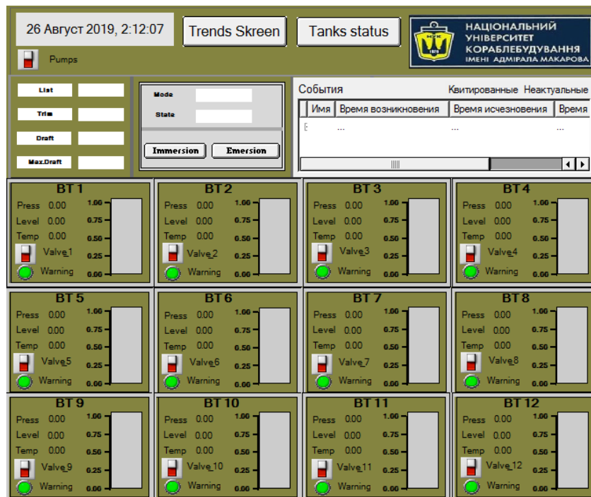
Рис. 4.6. Людино-машинний інтерфейс комп’ютерної системи контролю параметрів плавучого доку
