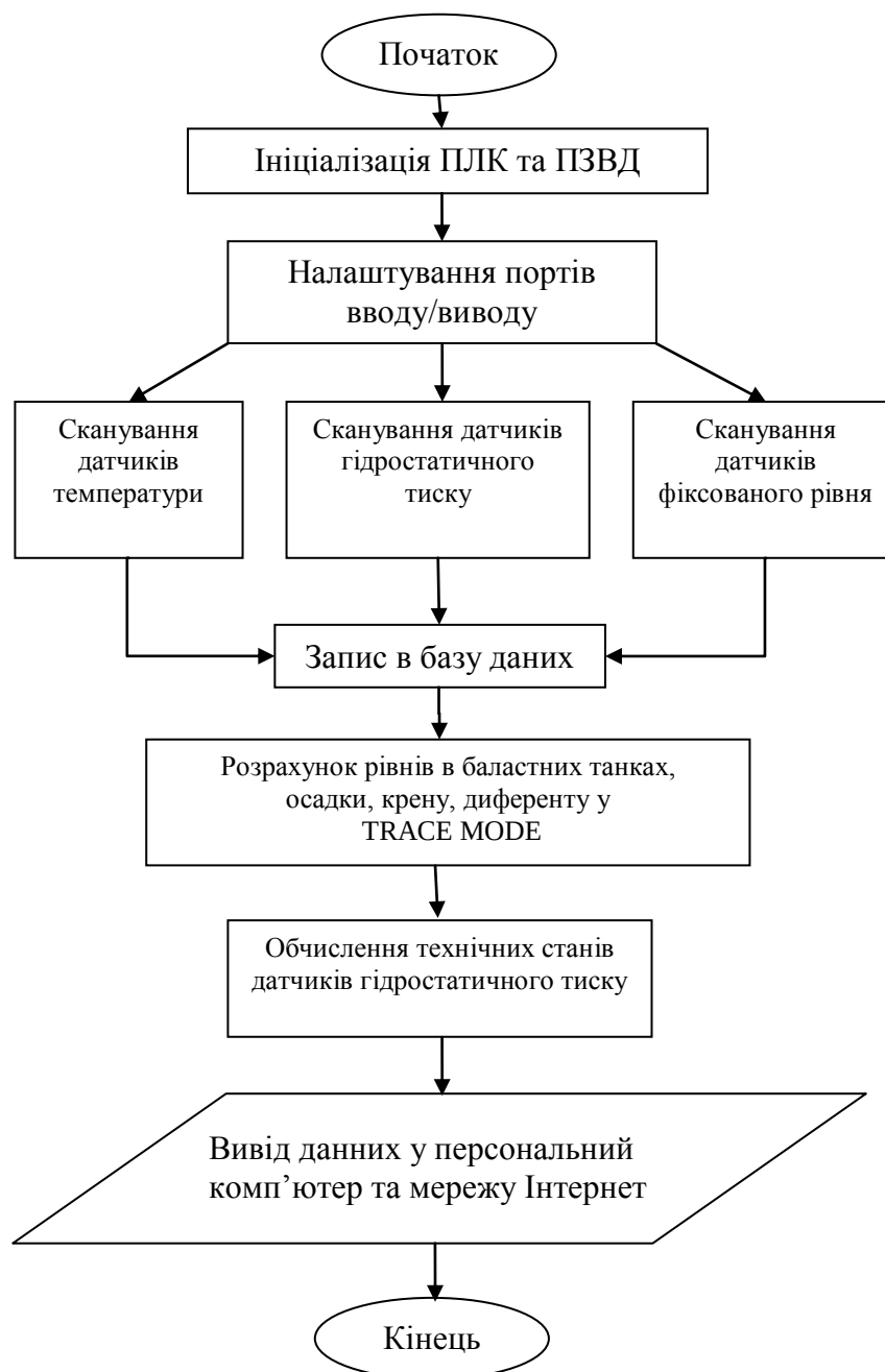
Рис. 4.2. Алгоритм роботи локальної частини СКС контролю параметрів плавучого доку
