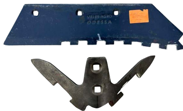
Рис. 1. Вирізані спеціальні вікна у зоні приварювання для приварювання зносостійких біметалевих пластин отриманих за допомогою електрошлакового наплавлення
