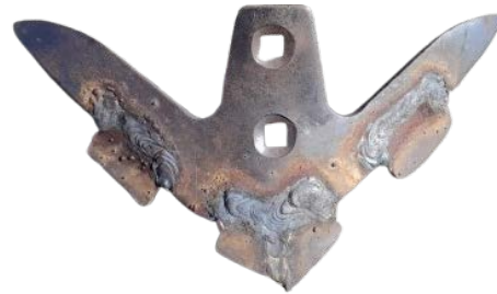
Рис. 3. Відновлений леміш (а) та культиваторна лапа (б) компанії «Велес-Агро Одеса» з привареними пластинами з наплавленим електрошлаковим покриттям (різально-лезвийна частина)
