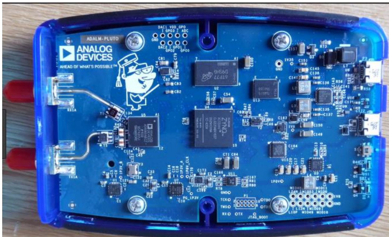
Рис. 1.2. Внутрішній вигляд платформи ADALM-PLUTO SDR
