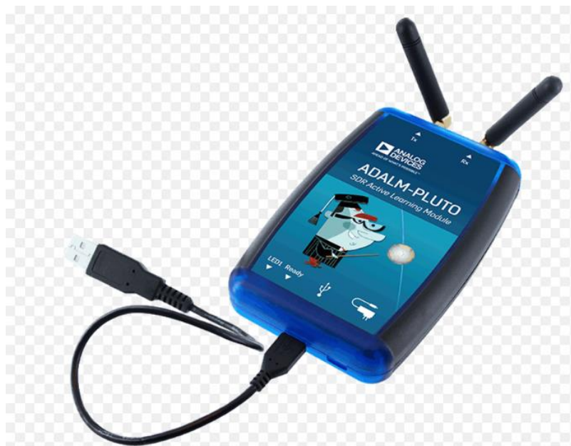
Рис. 1.1. Зовнішній вигляд платформи ADALM-PLUTO SDR
