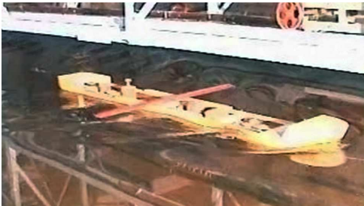
Рисунок Л.1 – Буксировка модели 1 (исходные обводы)
