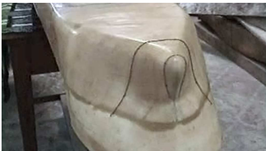
Рисунок 3.2 – Носовая часть модели 1 (исходные носовые обводы)
