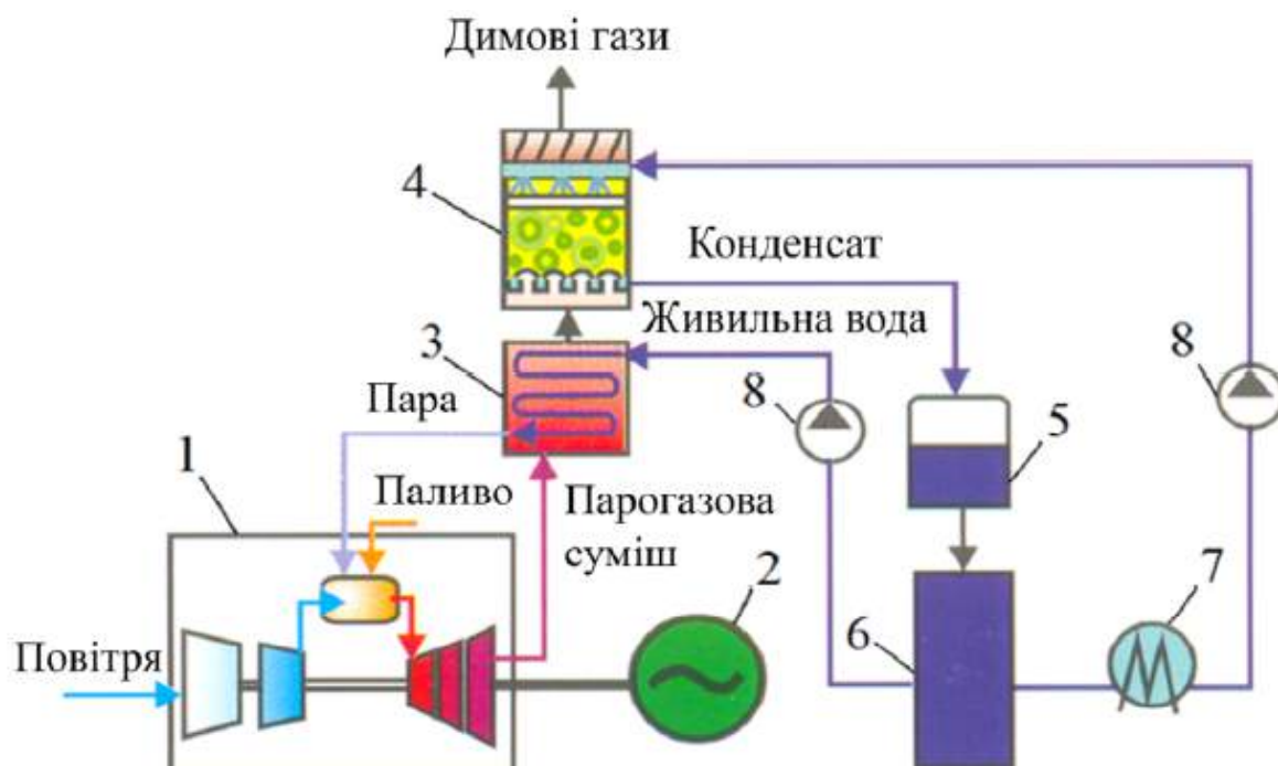
Рис. 1.14. Монарна парогазова установка (цикл «Водолій»:
