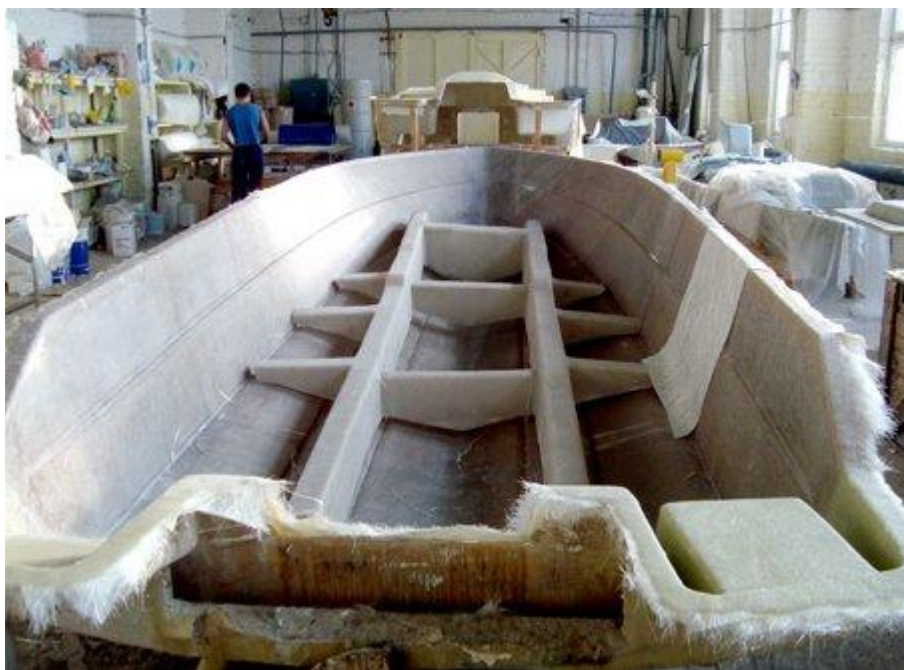
Рис. 2.3. Виготовлення корпусу моторної яхти зі склопластику.
