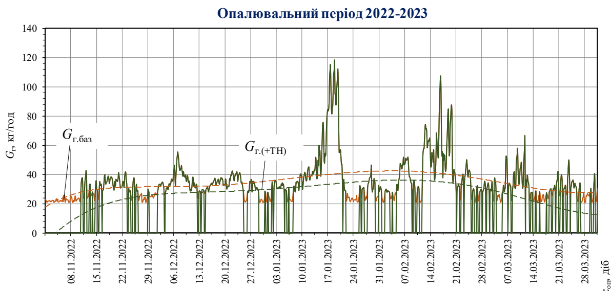
Рис. 4.9. Залежності питомої витрати природного газу для базової схеми із газовим котлом G_{r, \text{газ}} та витрати природного газу для комбінованої схеми із тепловим насосом G_{r, (+TH)} .
