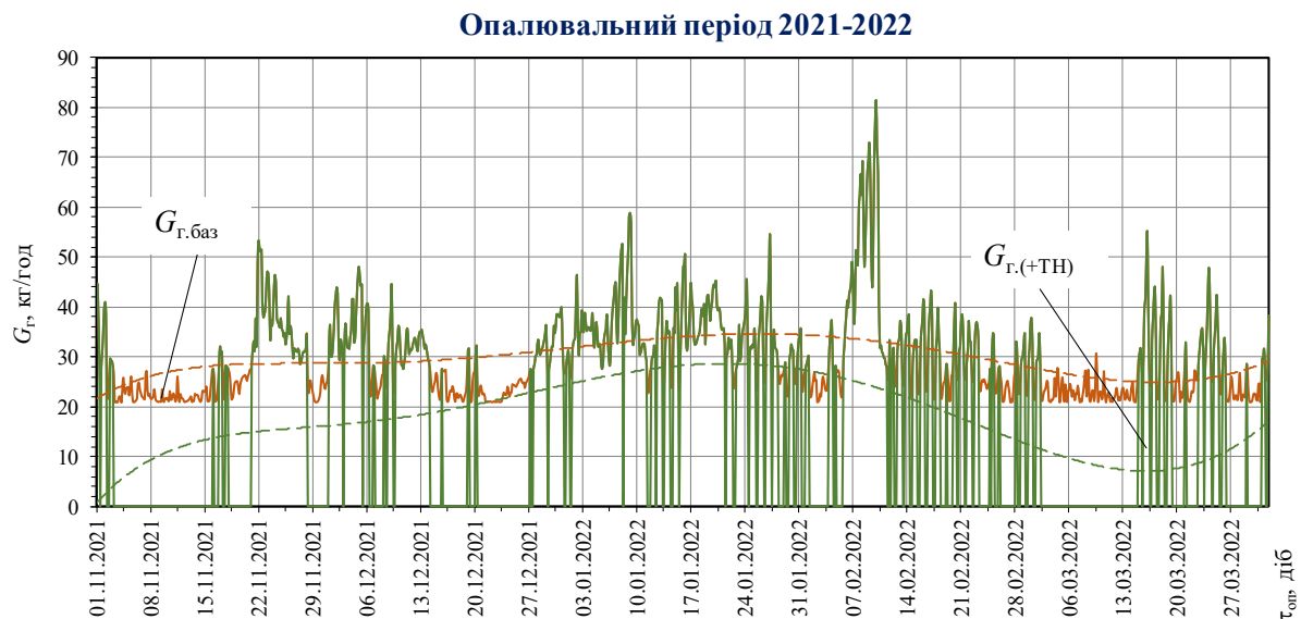
Рис. 4.5. Залежності питомої витрати природного газу для базової схеми із газовим котлом G_{T, \text{баз}} та витрати природного газу для комбінованої схеми із тепловим насосом G_{T(+TH)} .
