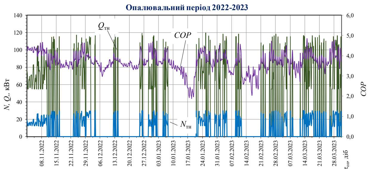
Рис. 4.11. Залежності коефіцієнта COP, теплове навантаження на тепловий насос Q_{TH} , електричне навантаження на тепловий насос N_{TH} при температурі теплоносія в системі опалення t_{w1} = 45^{\circ}C .
