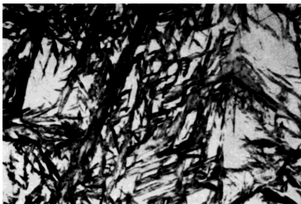
Рис. 1. Мікроструктура сталі 12Х2Н4А після гартування: темні голки – голчастий мартенсит; світлі ділянки – залишковий аустеніт
