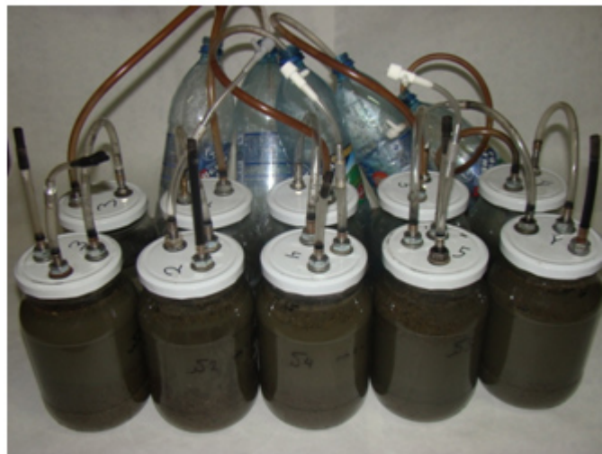
1 – ферментатор; 2 – газонакопичувач; 3 – ємність для вимірювання об'єму; 4 – штуцери; 5, 6 – пристрої для відбору проб; 7 – біомаса; 8 – вода
