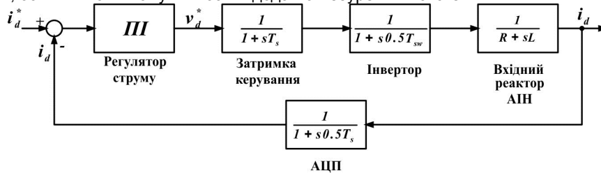
Рис. 3. Структурна схема контуру керування струмом
