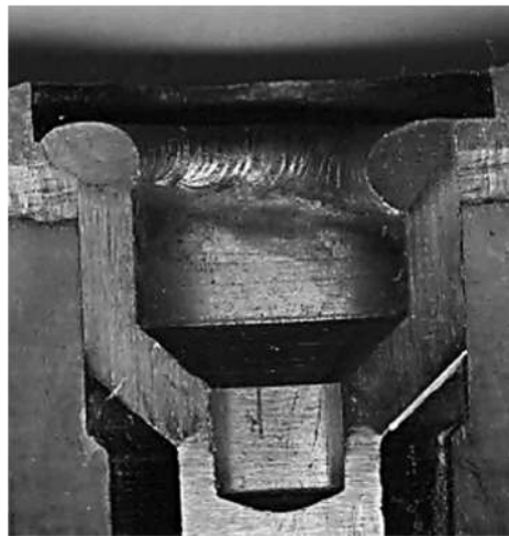
Рис. 3.5. Макрошліфи зварних з'єднань заглушки з трубною дошкою для двох варіантів технології:
