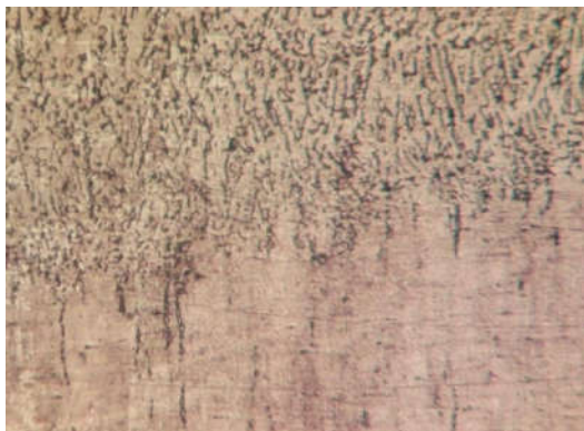
Рис. 3.8 Мікроструктура металу зон сплавлення, X200:
