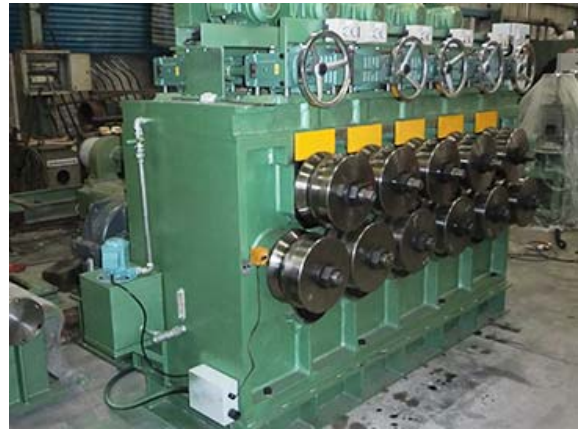
Рис. 1.4. Правка сортового прокату на машині JZJ20-40 [11]:
