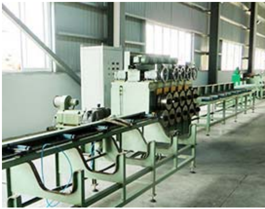
Рис. 1.4. Правка сортового прокату на машині JZJ20-40 [11]:
