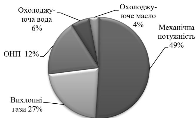
Рисунок 2.15 – Діаграма теплового балансу 6UEC50LSII
