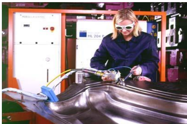
Рис. 1. Процес ручного лазерного наплавлення для відновлення штампів в промислових умовах з додаванням присаджувального дроту вручну та з використанням системи відео спостереження за процесом [7]
