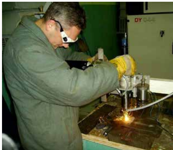
Рис. 2. Наплавлення ручним лазерним інструментом в напівавтоматичному режимі з присаджувальним матеріалом у вигляді порошку
