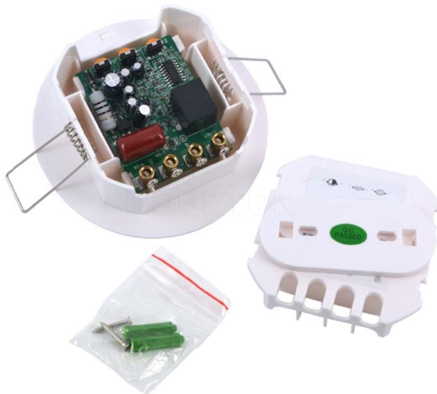
Рисунок 4.10 – PIR модуль датчик руху
