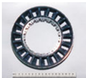
Рис. 1.3. Керамічні вироби для двигунобудування [17]: a – сопловий апарат; б – робоче колесо; в – газохід
