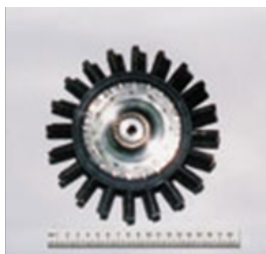
Рис. 1.3. Керамічні вироби для двигунобудування [17]: a – сопловий апарат; б – робоче колесо; в – газохід
