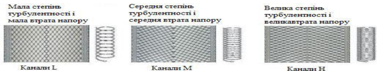
Рисунок 3.5 — Варіанти конфігурації міжпластинчастих каналів
