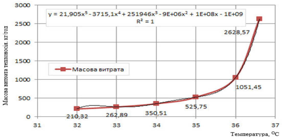
Рисунок 2.6 — Залежність масової витрати охолоджувального середовища від коливань температури морської води на вході в теплообмінник
