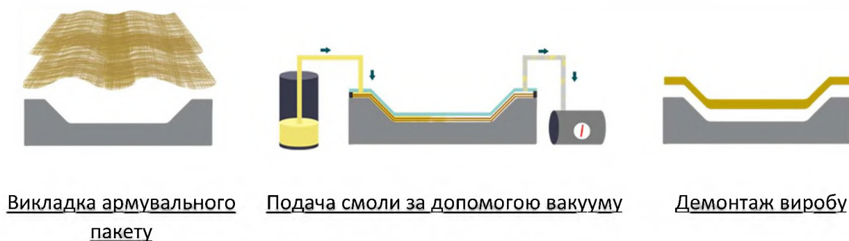
Рисунок 4.2. Процес виготовлення виробу шляхом вакуумної інфузії
