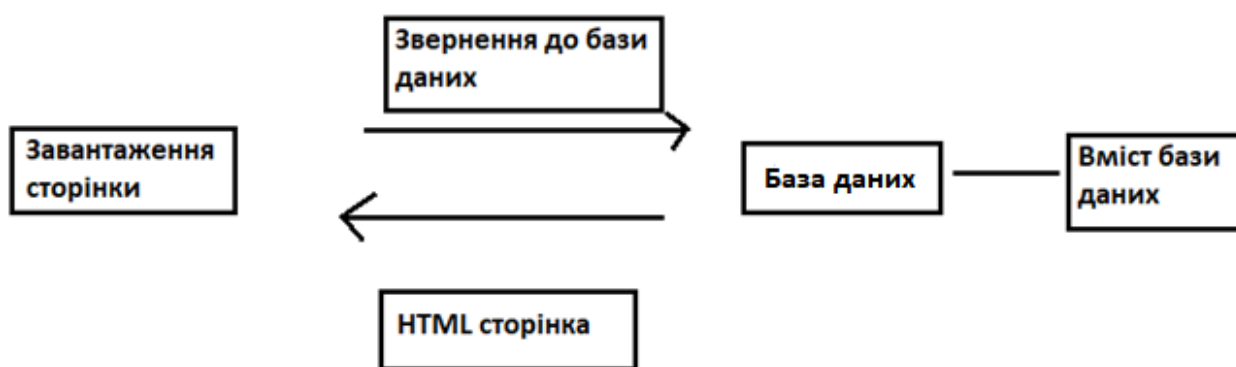
Рис. 3.7. Принцип роботи МРА
