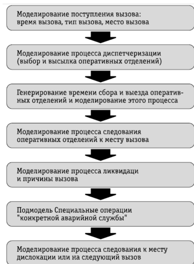
Рис.1.11. Схема алгоритму моделювання обслуговування одного виклику
