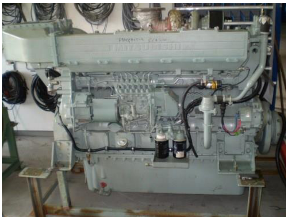
Рисунок 1.3 — Загальний вигляд дизель — генератора Mitsubishi Marine Diesel Engine Model: S6A3 ( а ) і дизеля Mitsubishi S6A3( б )
