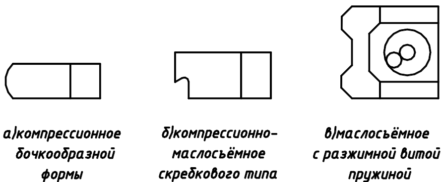
Рисунок 3.3 Профілі компресійних і маслоз'ємних кілець.
