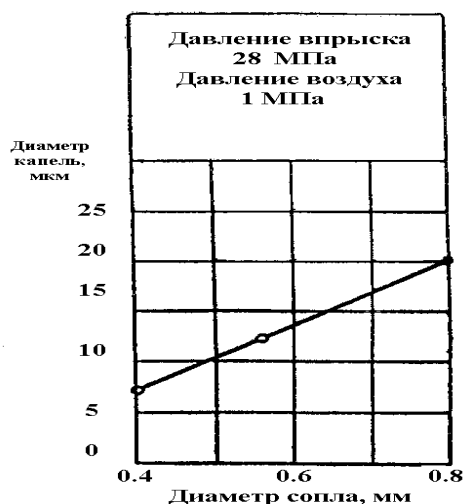
Рис. 3.3. Залежність діаметру крапель палива від діаметру соплових отворів форсунки
