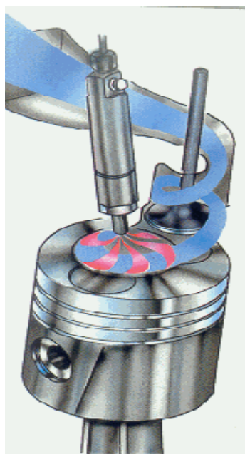
Рис. 3.6. Схема вихрового руху повітря
