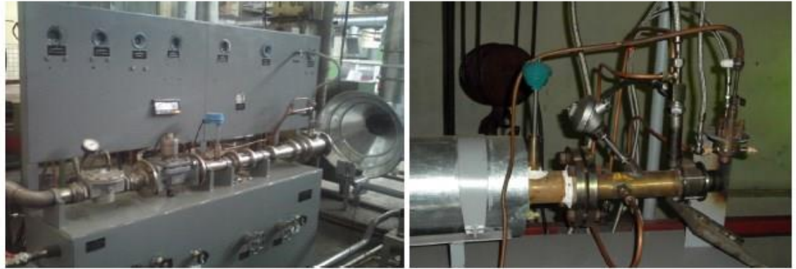
Рисунок 1.1 – Стенди для дослідження палиникових пристроїв [9]
