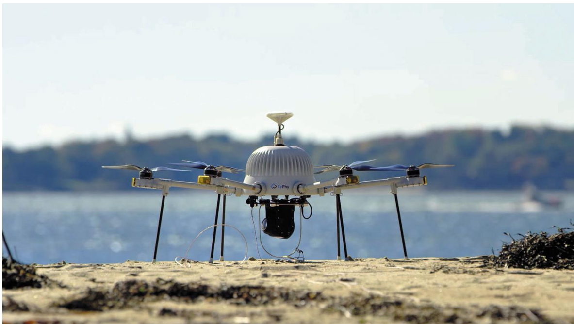
Рис. 1.1 – БПЛА для забору проб води
