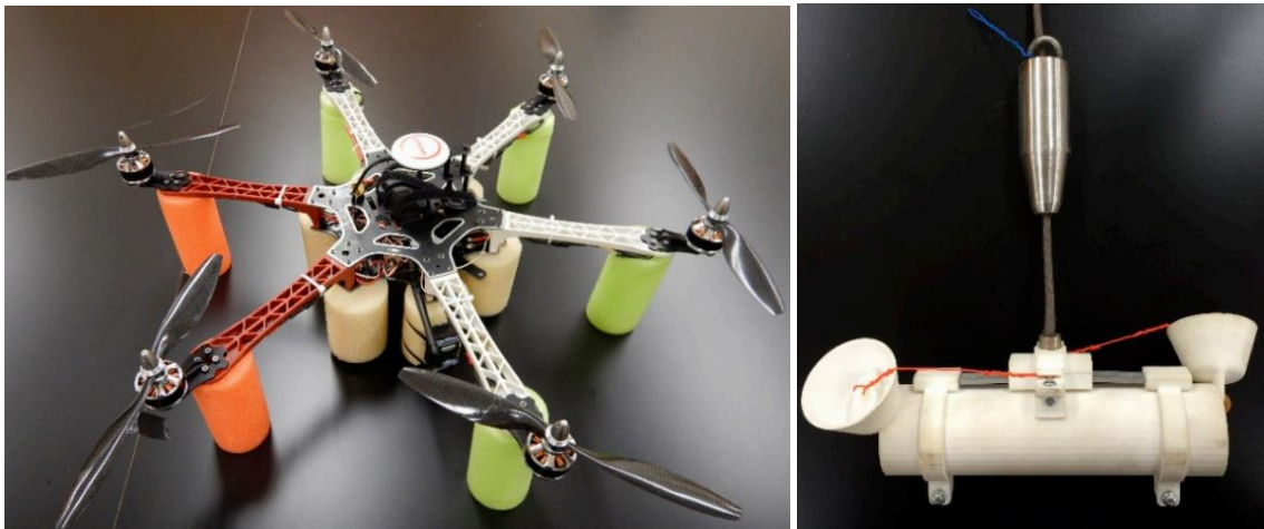
Рис. 1.2 – БПЛА з плавучим обладнанням:
