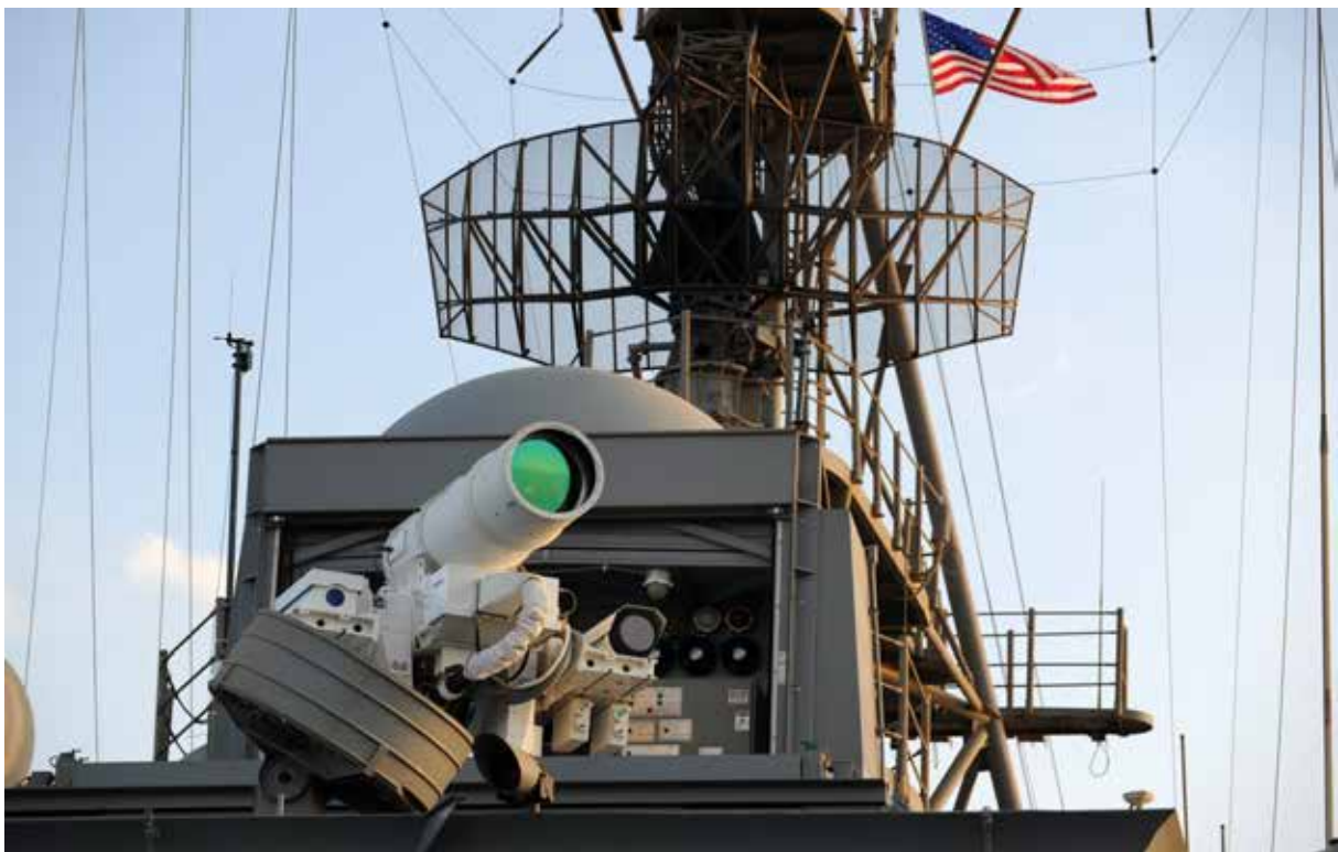
Рис. 4. Лазерна система AN/SEQ-3 розташована над командним мостиком USS Ponce [4]
