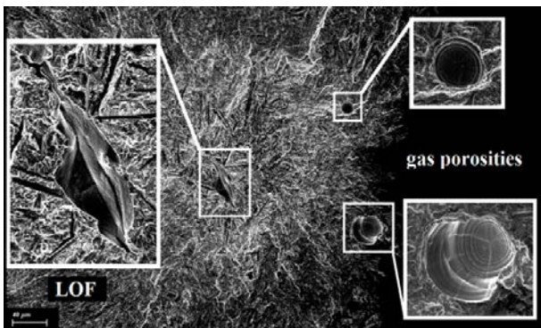
Рис. 1. Два основні типи внутрішніх дефектів на поверхні руйнування сплаву Ti-6Al-4V, виготовленого методом LPBF (SEM-аналіз) [5]
