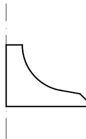
Рис. 6.5. Замкнений контур і осьова лінія, створені для побудови тарілки за допомогою команди Revolve (Обертання)
