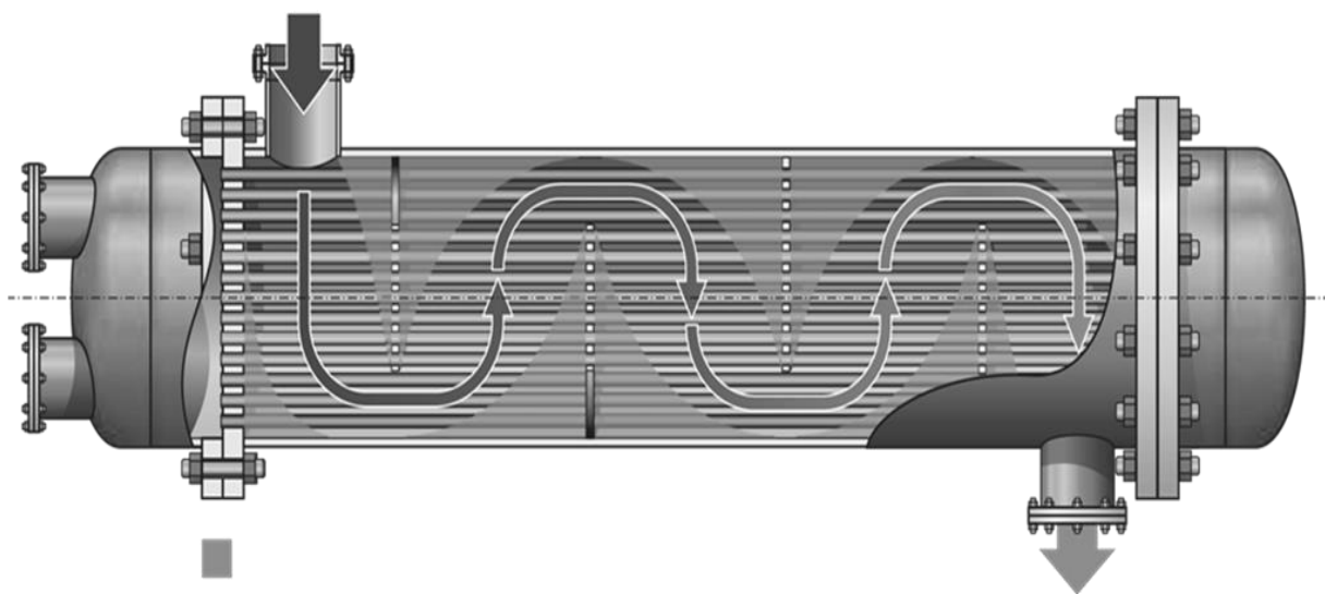
Рисунок 2.8- Схема роботи кожухотрубного теплообмінного апарату
