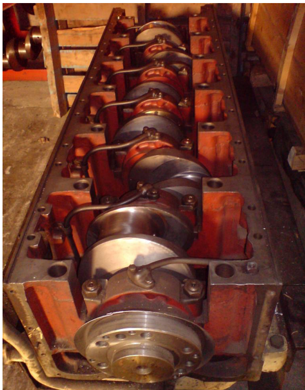
Рисунок 1.4 – Фундаментна рама з колінчастим валом
