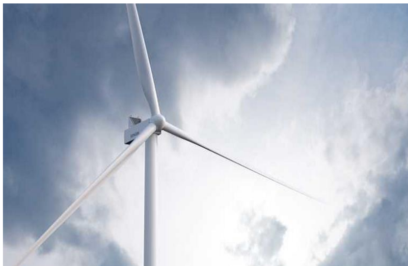
Рис. 1.9 – ВЕУ марки Vestas, модель V150-5.6
