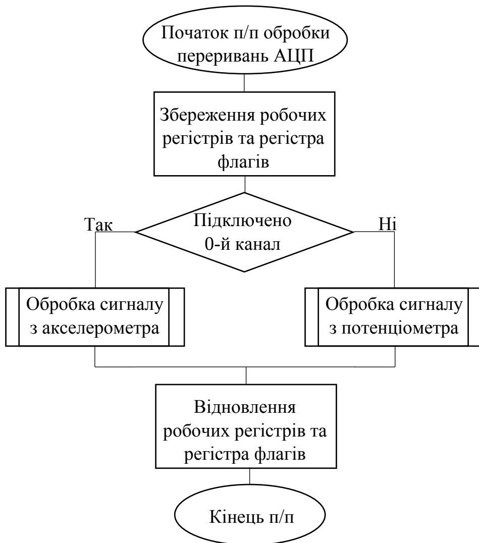
Рисунок 4.6 – Підпрограма обробки переривань АЦП
