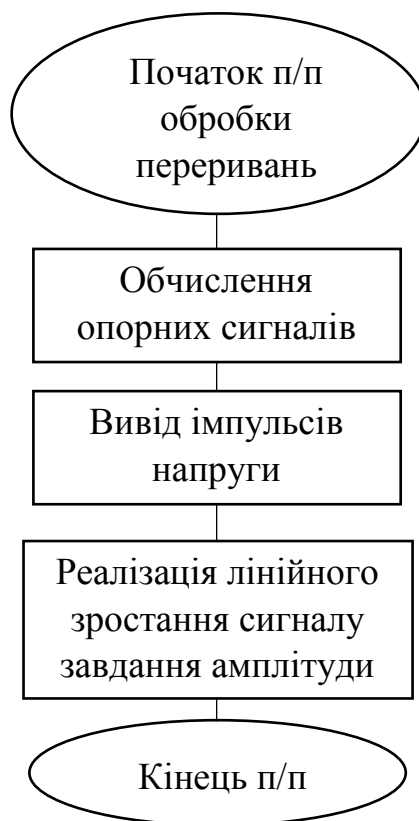
Рисунок 4.8 – Підпрограма обробки переривань таймера
