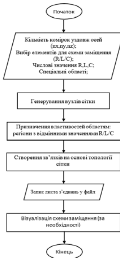
Рис. 4. Блок-схема алгоритму, який створює електричну схему заміщення у вигляді листа з'єднань для програми LtSpice
