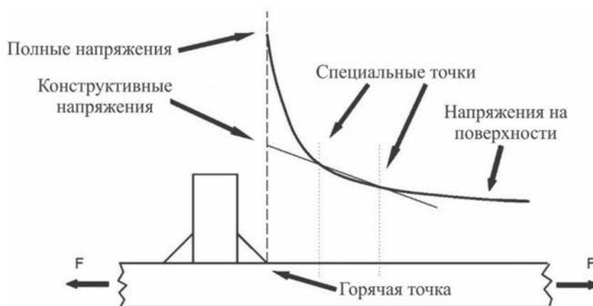
Рис. 4. Определение конструктивных напряжений в «горячей» точке посредством линейной экстраполяции
