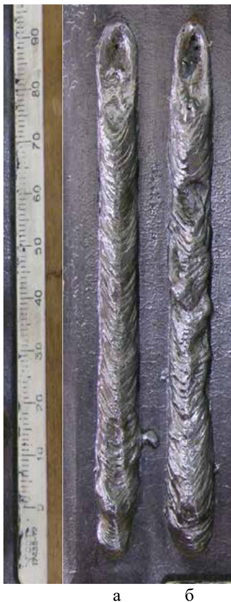
Рис. 6. Зовнішні види валиків, наплавлених на вертикалі: а - з імпульсною подачею електродного дроту; б - без імпульсної подачі
