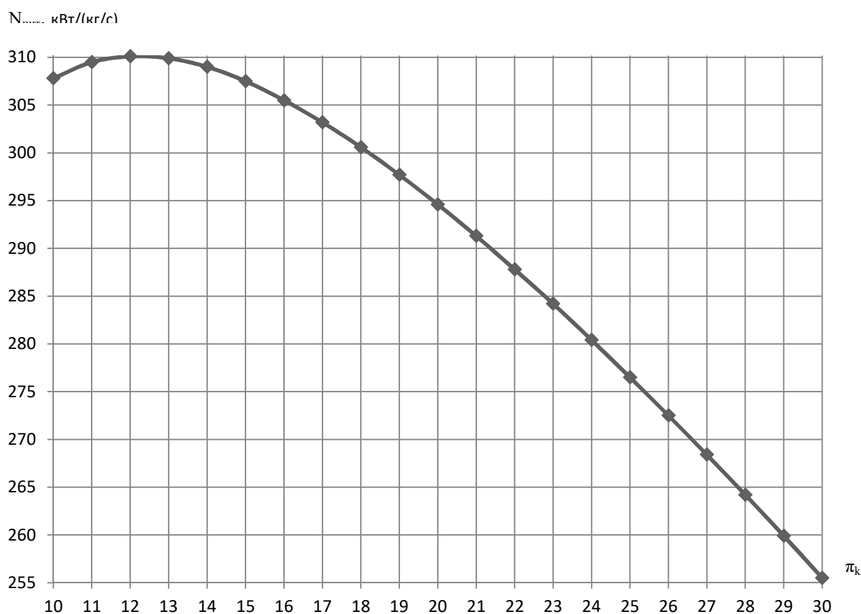
Рисунок 2.3 - Залежність питомої потужності циклу ГТА від міри підвищення тиску
