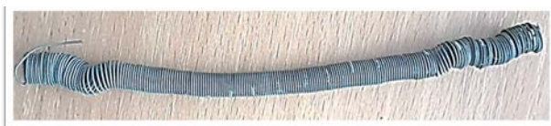
Рис. 2. Загальний вигляд пружини після занурення в теплу воду ( +60^{\circ}\text{C} )
