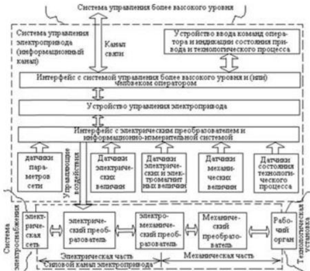
Рис. 1.7 - Загальна структура системи керування електроприводом
