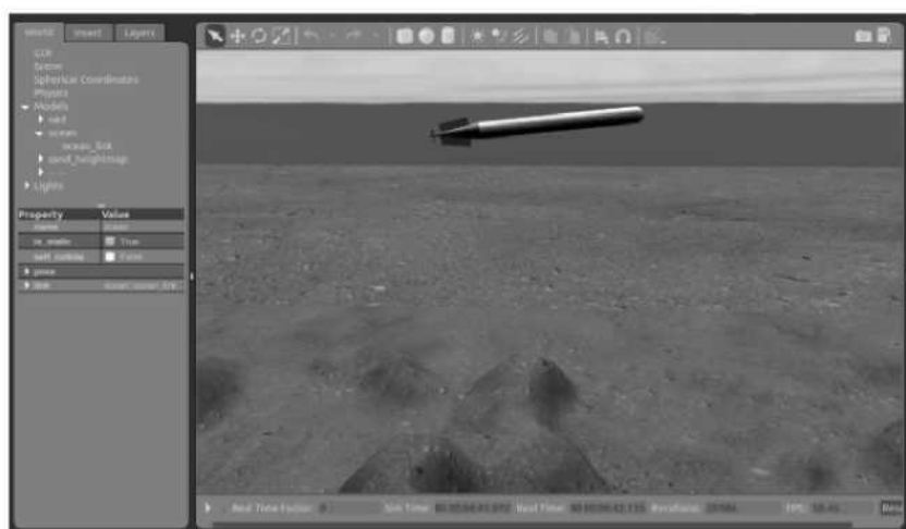
Рисунок 3.28 – Модель АНПА у віртуальному світі, реалізовані у пакеті моделювання Gazebo
