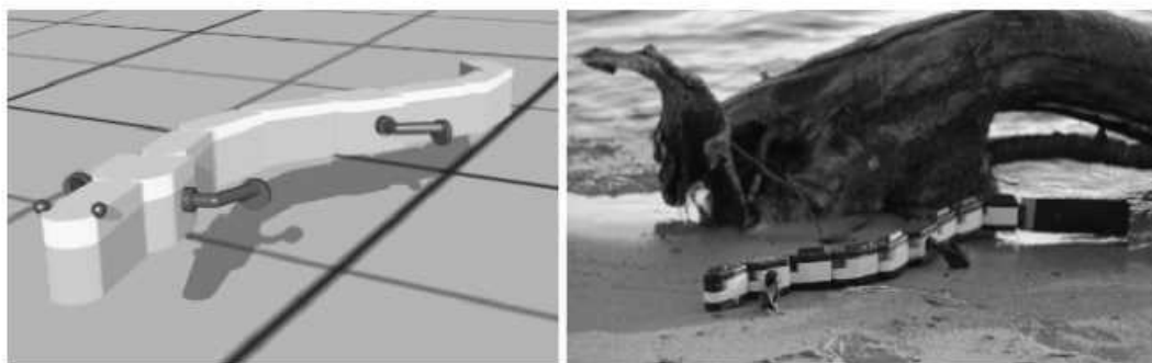
Рисунок 1.8 – Робот саламандр, керований моделлю спинного мозку Webots
