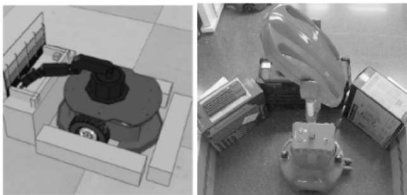
Рисунок 1.5 – Модель робота PR2 у симуляторі Gazebo (ліворуч) та його технічна реалізація (праворуч)
