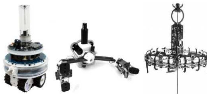
Рисунок 1.10 – Реальні моделі роботів зліва направо: foot-bot. hand-bot та eye-bot
