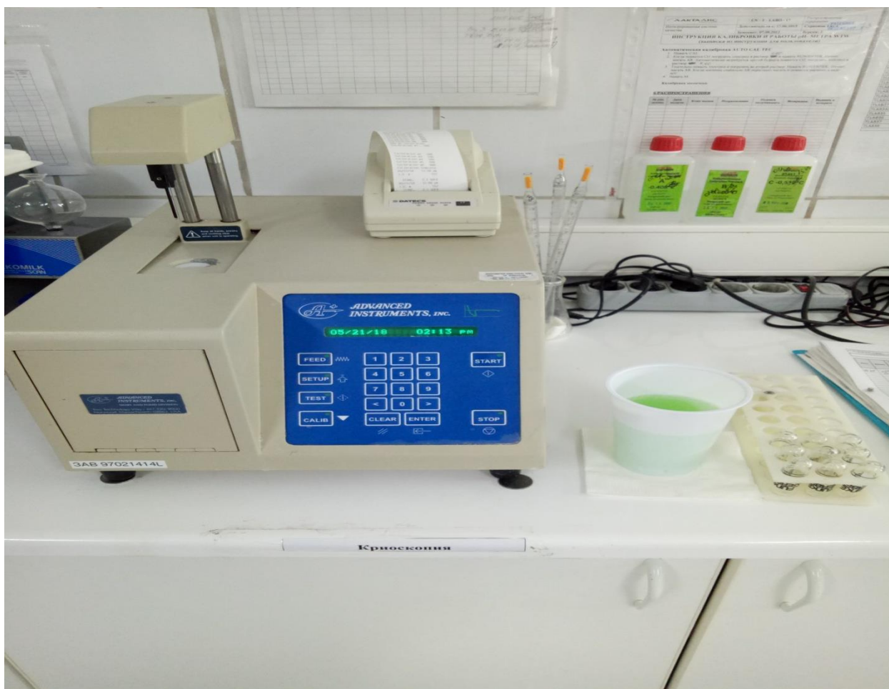
Рис. 3.5 – Прилад для вимірювання кількості води в молоці
